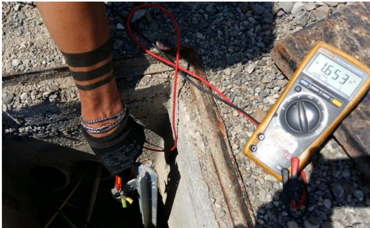
Fig. 27 - Valori di potenziale sul picchetto di messa a terra
