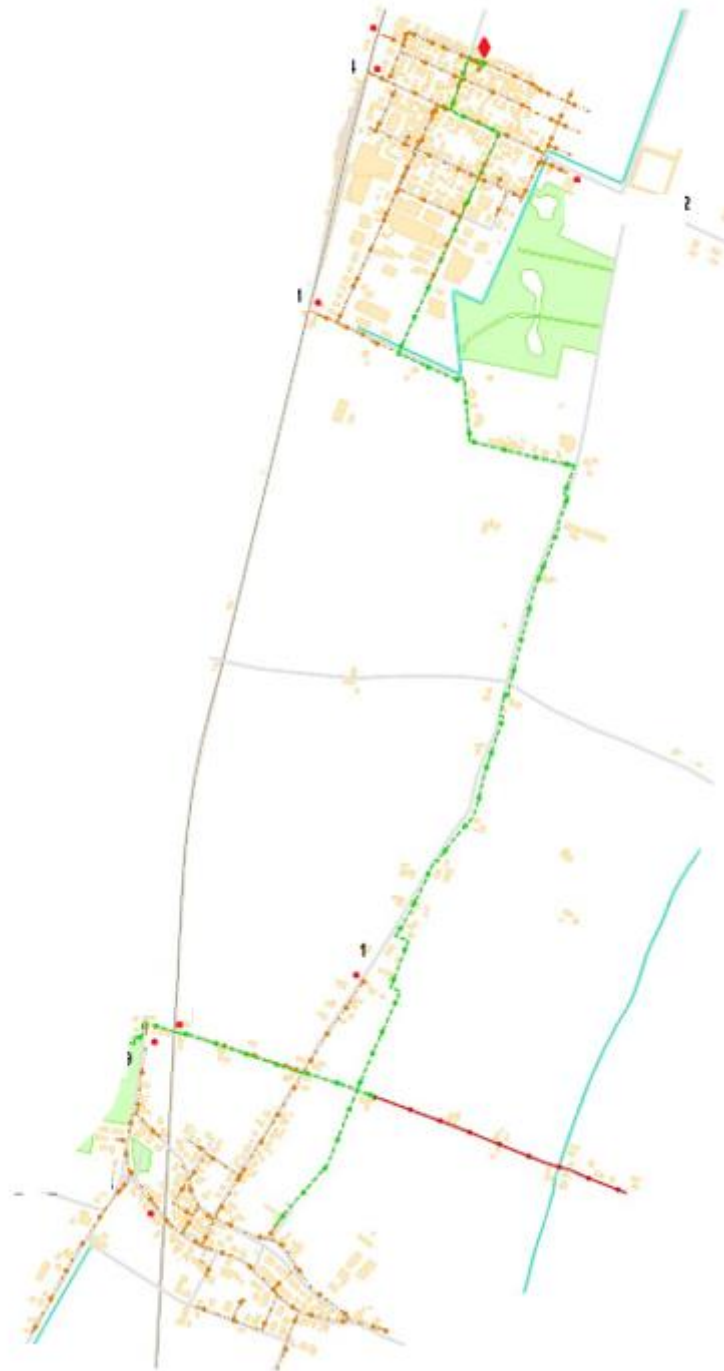
Fig.4 – Planimetria sistema protezione catodica e ubicazione impianto a corrente impressa
